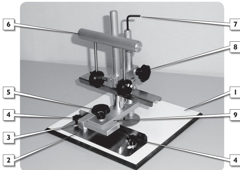
ungsknopfes (5) unterschiedliche Stempelplatten (10) festgemacht werden. Die Höhe kann mit dem Einstellknopf (8) entweder nach oben oder unten fixiert werden. Die Stempelplatte wird mit dem Handgriff des Hebemechanismus (6) auf die Seife gedrückt und stempelt diese.
