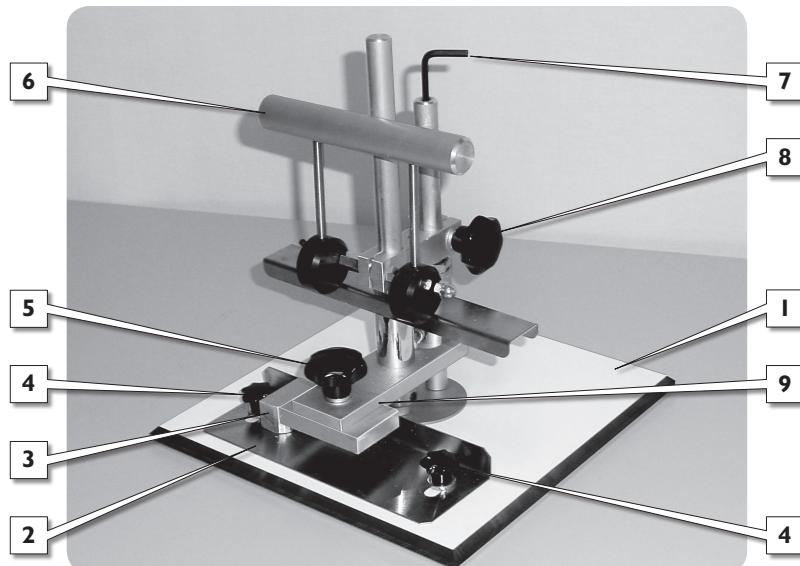
Des tampons (10) aux motifs divers peuvent être placés dans le support de tampon (9) à l'aide du bouton de fixation (5).
