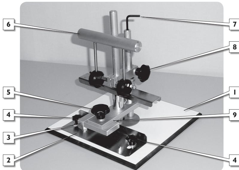
De hoogte kan worden ingesteld door de instelknop (8) los te maken en deze knop omhoog of omlaag te bewegen.
